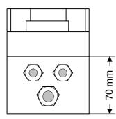
Material: Polyester with glass fiber, self-extinguish acc. UL 94-VO Colour of casing: orange, RAL 3001 Colour of toggles, glands and mic cover: black Weight: approx. 4 kg Material: Glasfaserverstärktes Polyester, schwer entflammbar nach UL 94-VO Gehäusefarbe: orange, RAL 3001 Schwenktaster, Verschraubungen, Mikrokorb: schwarz Gewicht: ca. 4 kg
