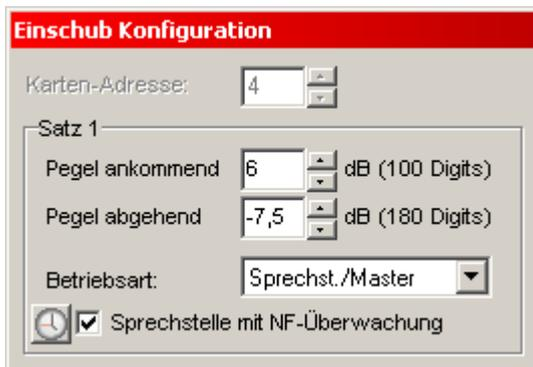
Zum Anschluss der Sprechstelle an die DVS-21 wird in der Anlage ein Einschub 4NSA mit 7kHz - Überwachungsaufsatz (Bestell-Nr. 2.301) benötigt.
