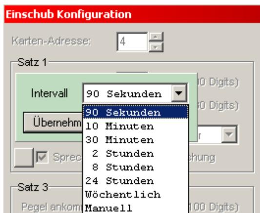
Für die Aktivierung der Funktionalität „Feuerwehrsprechstelle“ ist es erforderlich, in der Konfigurationsmaske für den Einschub 4NSA die NF-Überwachung zu aktivieren.
